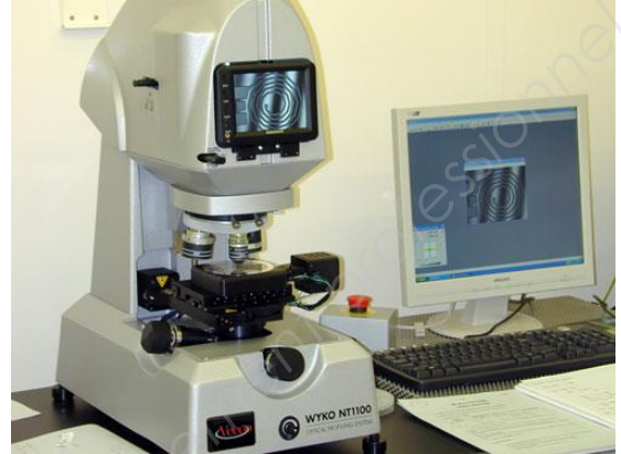
Figure 1 : Microscope interférentiel Wyko NT 1110
