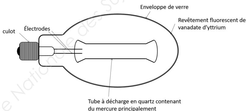
Le vanadate d'yttrium dopé à l'euporium sert de luminophore : lorsqu'il subit une excitation, il émet de la lumière. Une grande partie du rayonnement UV est ainsi converti en rayonnement correspondant aux grandes longueurs d'onde du visible et à des IR.
