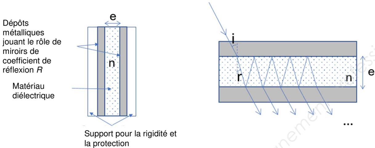
Figure 5 : schémas de principe d'un filtre interférentiel
